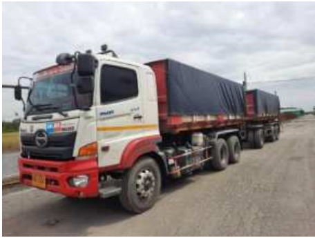
ภาพที่ 2.2-1 การใช้ผ้าปิดคลุมท้ายรถบรรทุกสินค้า ก่อนออกจากโครงการ
